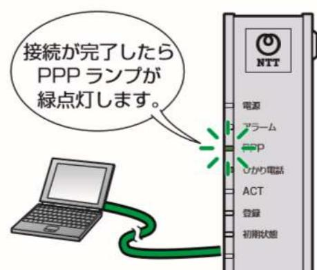
すでに機器設定用パスワードを設定したり、上記設定画面にてプロバイダ等の設定が済んでいる場合は、上記の①で「<http://ntt.setup/>」もしくは本商品のIPアドレス「<http://192.168.1.1/>」(工場出荷時)を入力すると③の画面が表示されますので、「ユーザー名」と「パスワード」を入力してください。
