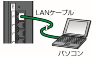
**1** Webブラウザを起動し、アドレス欄に「<http://ntt.setup/>」もしくは本商品のIPアドレス「<http://192.168.1.1/>」（工場出荷時）を入力する
